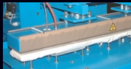
Trennfolie aus PTFE Glasgewebe, auf einer Bügelpresse. | Non stick fabric on a hot Ironing press.
