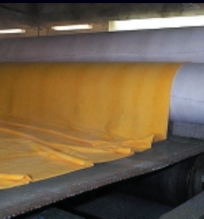
10 Walzenbewicklung aus Polyester Vlies, auf einer Bedämpfungs-Maschine für Wirkwaren. | Cylinder covering made of Non Woven Polyester, on a steaming machine for knitted fabrics.
