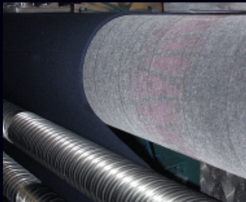
Walzenbewicklung aus einem Kunstfaserbelag, auf einer Spannrahmen Einzugswalze. | Cylinder covering made of Chemical Fibres, on a stenter frame roller.
